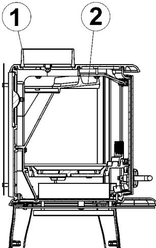
Проверьте, чтобы дефлектор (2), огнеупорные кирпичи и дымоотводящий патрубок были смонтированы правильно.
